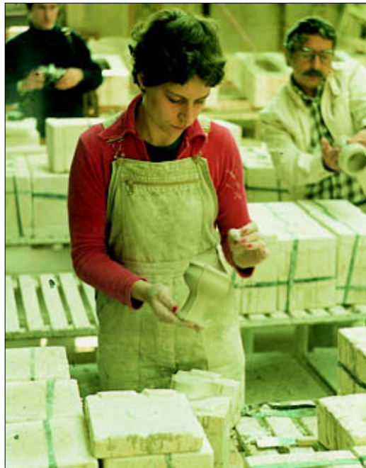
Figuur 4.15 Een mal bestaat uit één of meer delen
