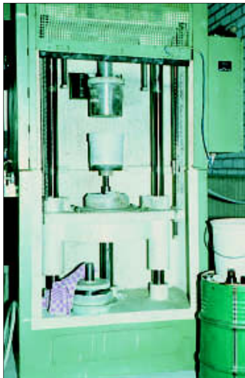
Figuur 4.19 Persen kan alleen als de contramal er nog uit kan
