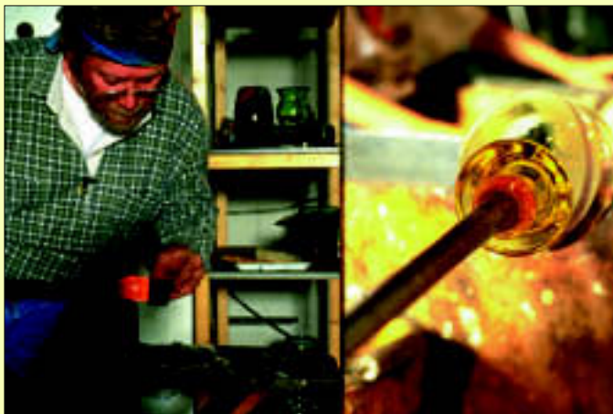
Figuur 4.34 Uit de oven wordt met behulp van een blaaspijp een 'hulpstuk' gehaald. Dit hulpstuk noemen we de 'pontil'. Deze wordt aan de voet van de vaas gesmolten. De blaaspijp aan de hals van de vaas wordt nu afgetikt
