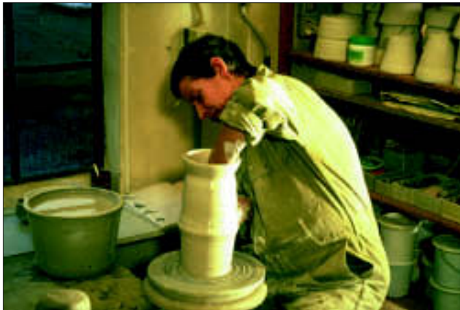
Figuur 4.13 De wanddikte van de vaas bepalen
