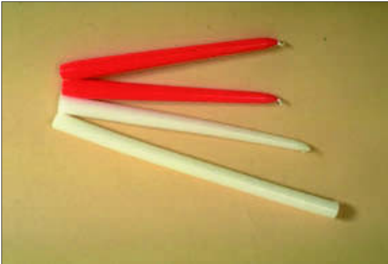
Figuur 4.59 Langwerpige kaarsen kunnen ook worden geperst. Ze hebben een gladder oppervlak en worden aan de boven- en onderkant bijgeslepen
