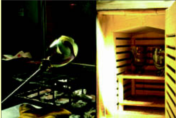
Figuur 4.38 a) De vaas wordt van de blaaspijp afgetikt. Het breekpunt blijft wat ruw en is het 'pontilmerk'; b) Binnen 35 seconden moet de vaas in een afkoeloven van 535 °C worden gezet. Na twee uur wordt de oven uitgezet en koelt het glas in ongeveer 25 uur af. Dan is de spanning uit het glas. Gebeurt dit niet dan springt het glas in duizend stukken uit elkaar
