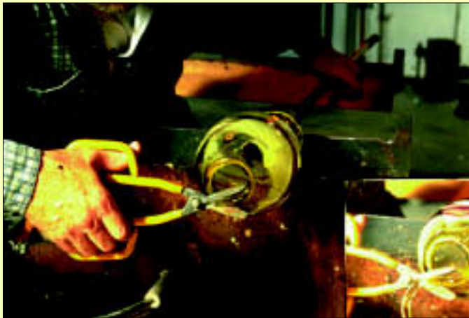
Figuur 4.36 De hals wordt met een schaar recht afgeknijpt
