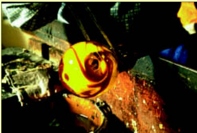
Figuur 4.28 Nadat de basisvorm is geblazen, wordt het glas aan de blaaspijpkant ingesnoerd met een tang
