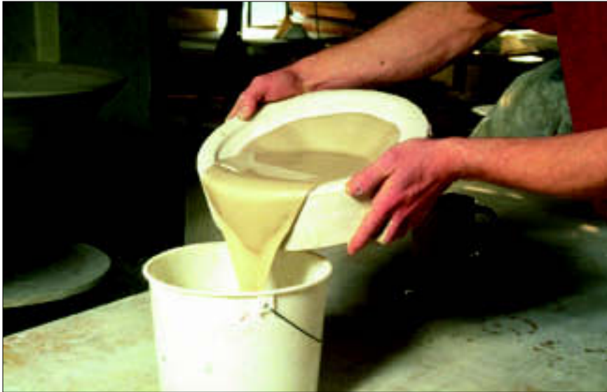
Figuur 4.17 Na enkele uren heeft het gips vocht onttrokken aan de klei. De mal wordt leeggegoten en er blijft een dunne wand achter
