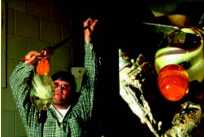
Figuur 4.32 a) Snel wordt de voet op de vaas 'geknipt'; b) Met een natte krant wordt de voet verder gevormd
