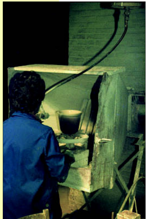
Figuur 4.5 Het voorwerp wordt in een spuitcabine geplaatst
