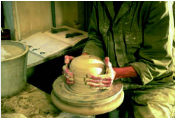
Figuur 4.10 Centreren van de klei
