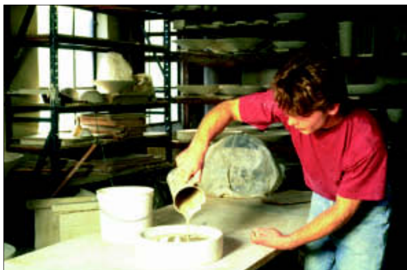
Figuur 4.16 De vloeibare klei wordt in een gipsen mal gegoten
