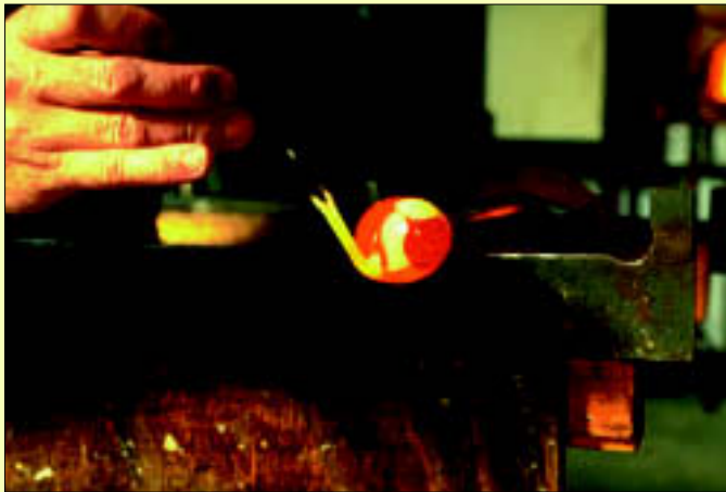
Figuur 4.24 Nadat de metaaloxiden op het postje zijn gesmolten, worden de kleuren met een tangetje in de gewenste positie gebracht
