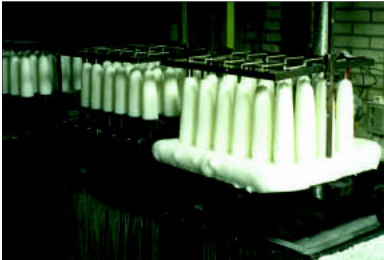
Figuur 4.56 Als de gewenste dikte is bereikt, wordt het overtollige kaarsvet afgesmolten om de kaars los te kunnen snijden
