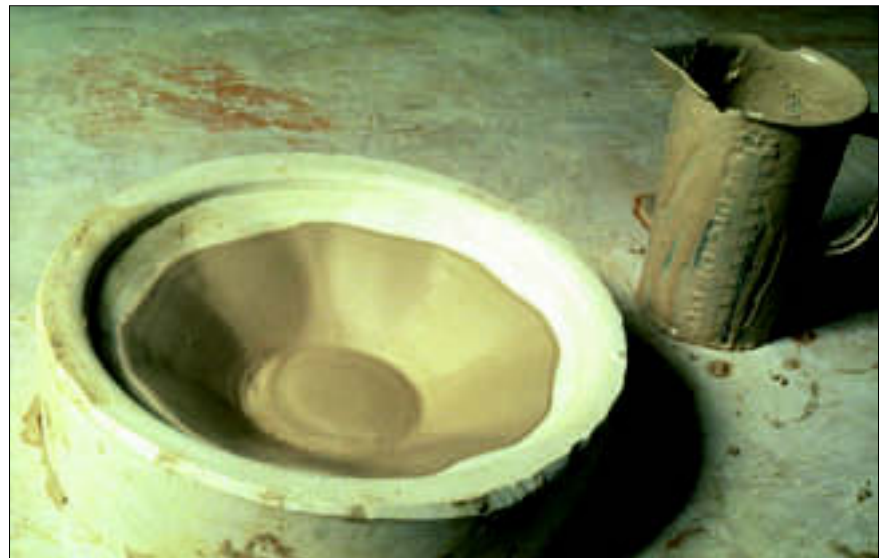
Figuur 4.18 Na het drogen kan de schaal uit de mal worden verwijderd
