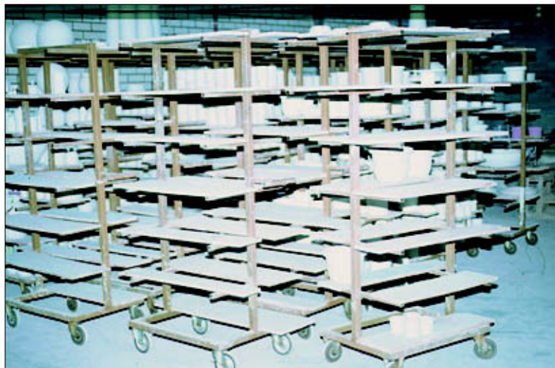
Figuur 4.4 Aardewerk kan op karren worden geplaatst om te drogen
